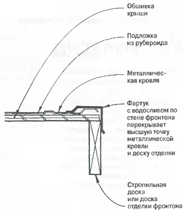
Рис. 4. Заделка уклона по линии фронтона
