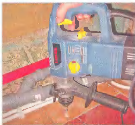
Сверлить отверстия в плитке и бетонном полу перфоратором быстро и удобно
