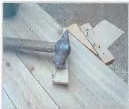
Для сплачивания щитов применили приспособление, известное с давних времен, — клиновую стяжку
